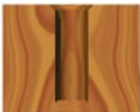
ESEMPIO DI FORO CIECO CON SVASATURA EXAMPLES OF BLIND DRILLING WITH COUNTERSINK BEISPIEL
