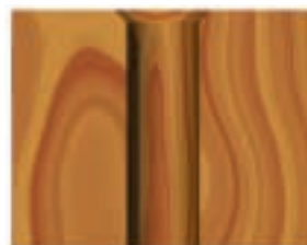
ESEMPIO DI FORO PASSANTE CON SVASATURA EXAMPLES OF THROUGH-OUT DRILLING WITH COUNTERSINK BEISPIEL
